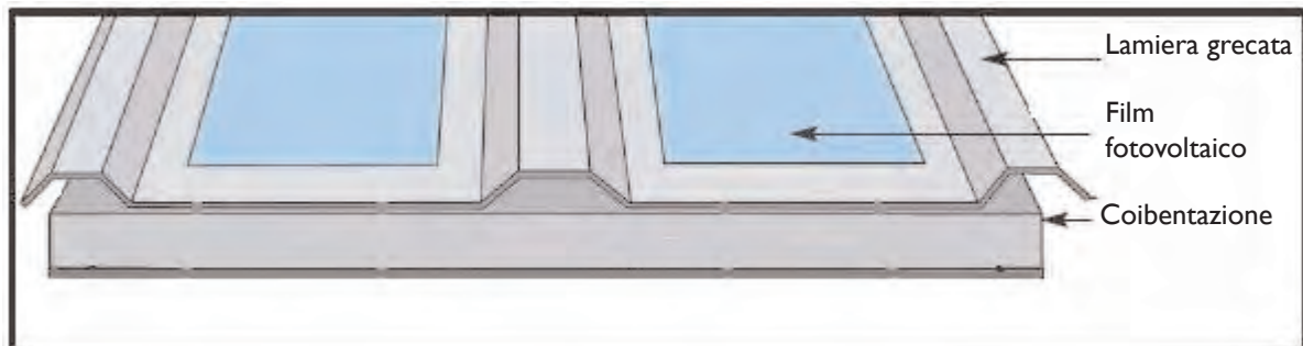
Figura 3. Modulo fotovoltaico non convenzionale consistente in film fotovoltaico su strato metallico sovrapposto a un pannello di coibentazione termica
